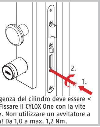
La sporgenza del cilindro deve essere < 3 mm. Fissare il CYLOX One con la vite frontale. Non utilizzare un avvitatore a batteria! Da 1,0 a max. 1,2 Nm.
